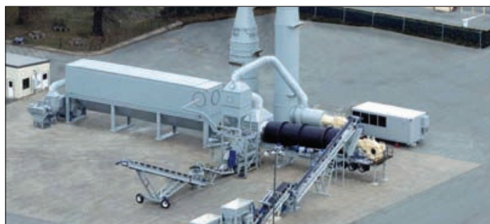
Trattamento di desorbimento termico in situ
