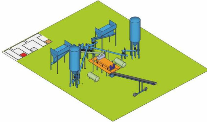
中和或稳定危险物质的过程是将污染物质，汇集于一个有机（有机聚合物、包封复合物）或无机（水泥、石灰、陶土）的惰性机体中，通过一种化学和/或物理过程，经过一段时间降低污染性及危险性，使其符合回收或填埋非危险性垃圾的标准。
