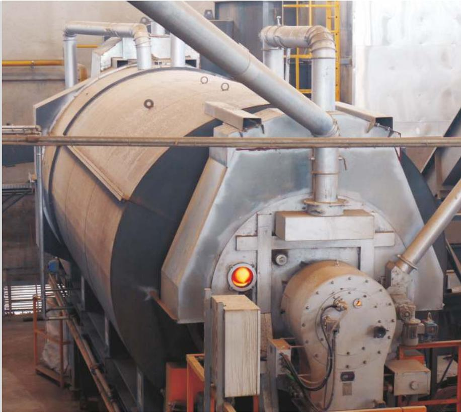
热能抽取处理，指的是处理固体（土地、沉淀物）或半固体（污泥）土壤所含的挥发性有机毒性物质（见表1）的过程，方法是加热被污染物，将污染物质导入气体状态，然后用适当方式进行中和处理。
