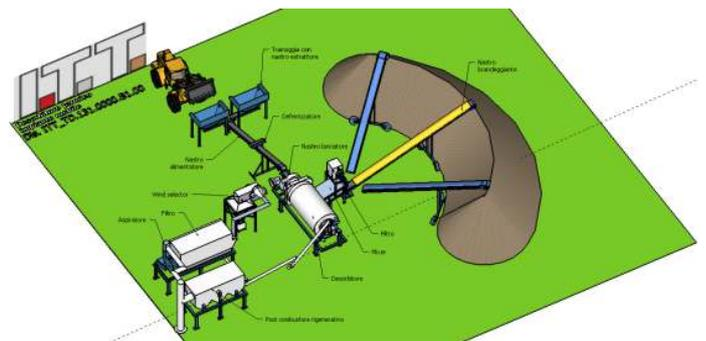
I.T.T. 公司供应旋转式烘干抽取设备，按照有待处理的土壤条件以及污染物性质，可分直接或间接加热。
