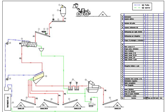
土壤清洗是一种修复污染土壤的技术，可在当地或其他地方进行，是用水以及表面活性剂、生物表面活性剂的水溶剂或有机溶剂，对土壤进行真正的洗涤。这个过程可以是物理性处理，即通过连续粒径式分离技术，将污染物质冷凝到原来容积的一部分（通常是极小部分）；也可以是化学性处理，即将污染物质转变成液体状态。
